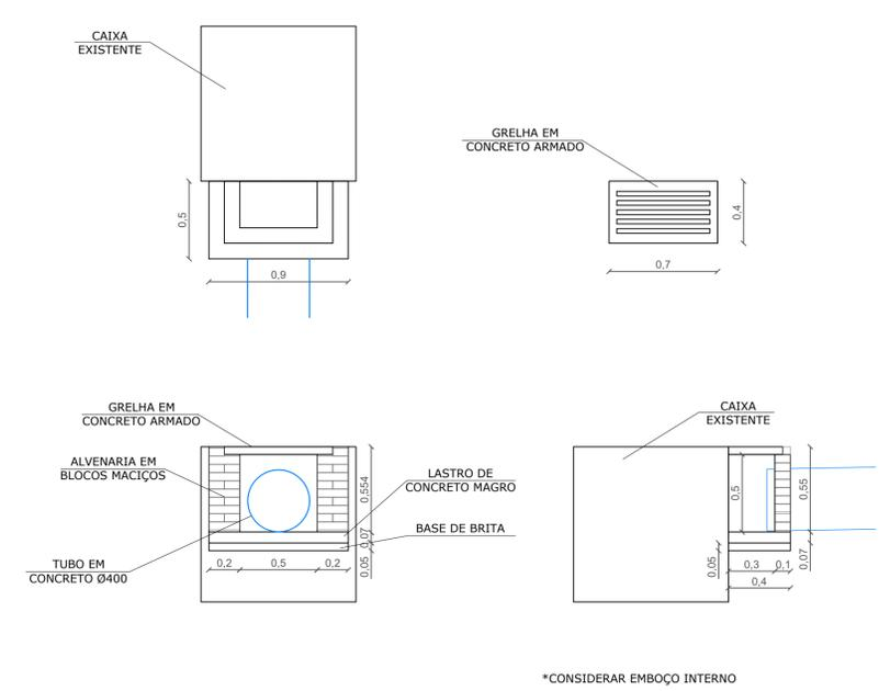
DETALHAMENTO ADAPTAÇÃO DA CAIXA EXISTENTE
